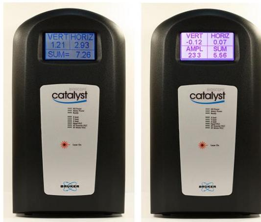
对于 Tapping 模式，将显示器上“Setup”界面中示意图显示的红色圆点调整到 Detector 的中心。此时 Vert. Defl.和 Hori. Defl.（不可见）都在 0 V 附近。
